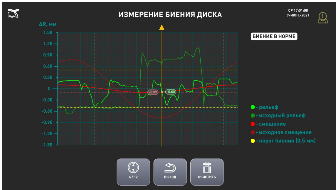
Рисунок 7.9 – Окно сравнения биений диска
