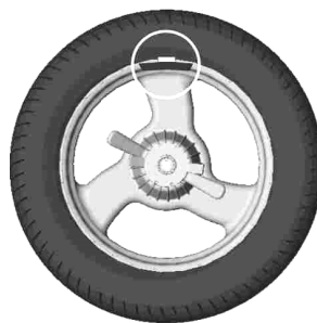
Рисунок 6.5 – Груз установлен в «12 часов»
