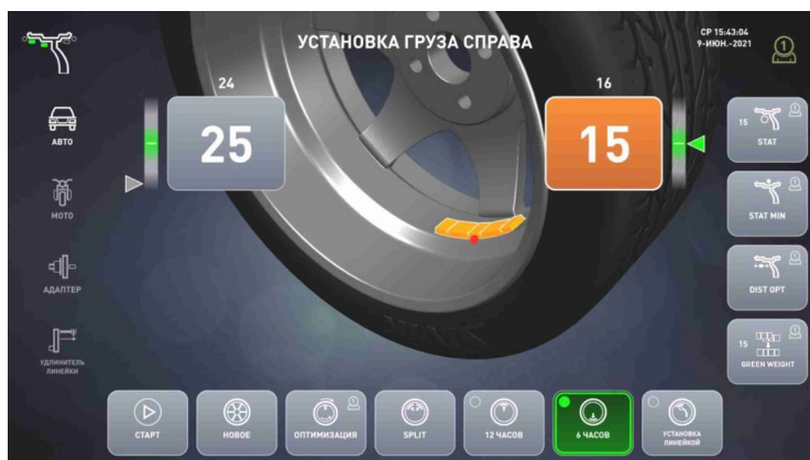
б – установка груза в «6 час»
