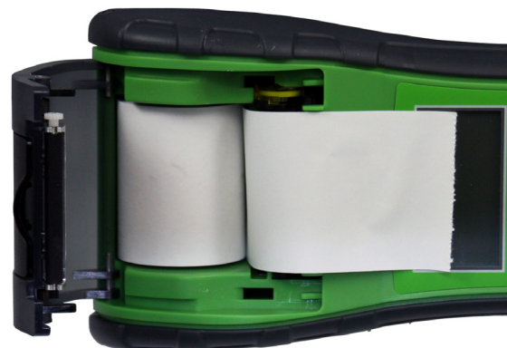
Рис. 4: Подача бумаги из-под рулона
