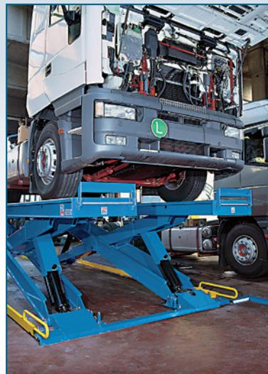
Поверхность платформы - стальная ребристая противоскользящая пластина
