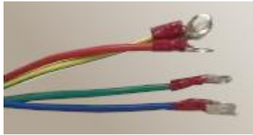
Рисунок 3.15 – Провода для подключения электродвигателя Красный, синий, зелёный – фаза Жёлтый – Земля
