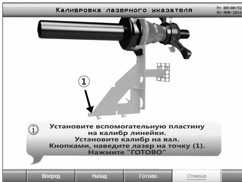
Рисунок 8.7 – Окно калибровки лазерного указателя
