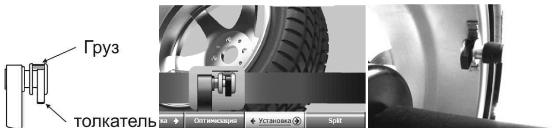
Рисунок 5.13 – Установка груза линейкой
