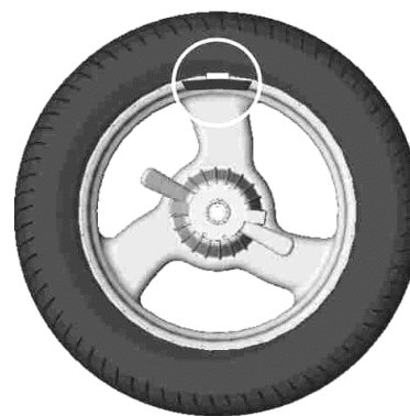
б - груз установлен в положение «12 часов»
