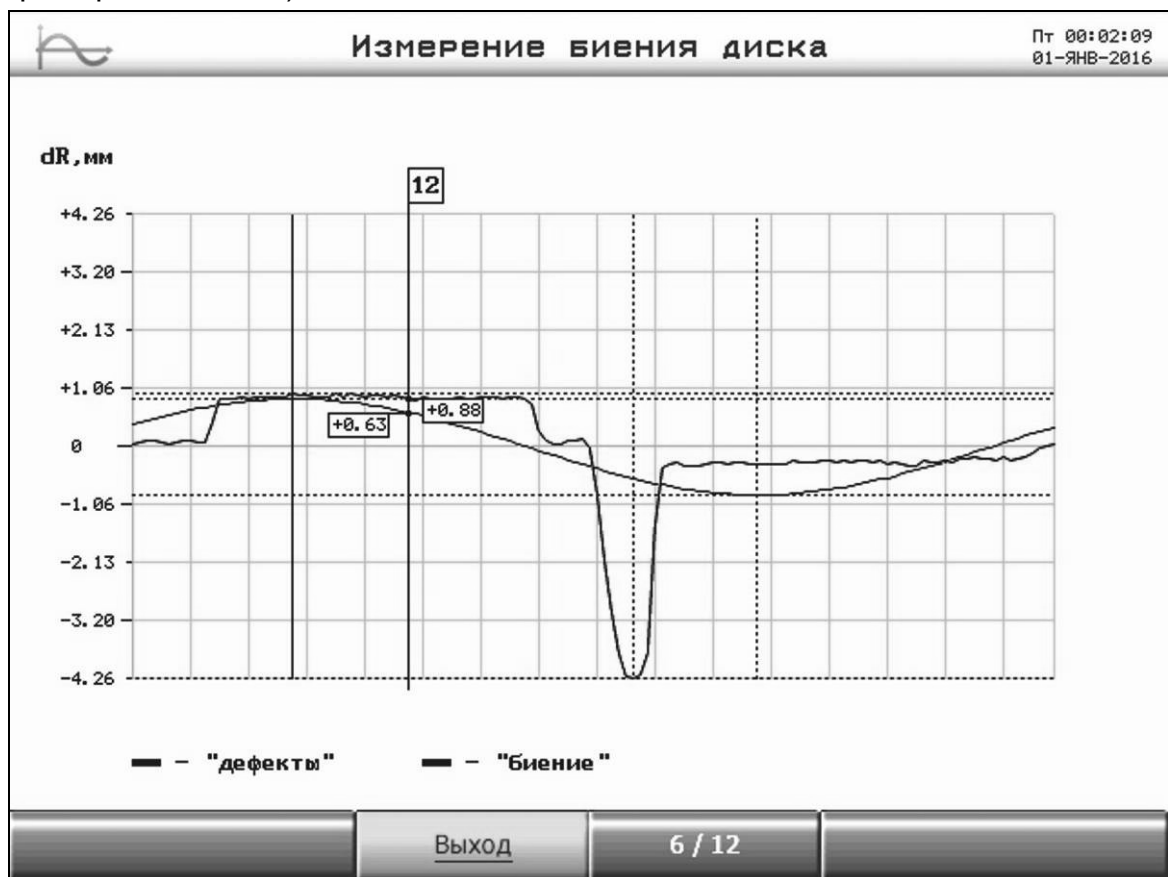
Рисунок 7.6 – Окно измерения биений диска
