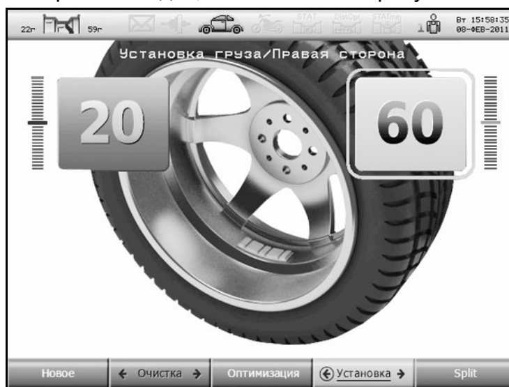
Рисунок 5.14 - Установка в «6 часов» справа
