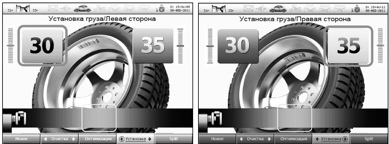
Рисунок 6.11 – Схемы установки грузов
