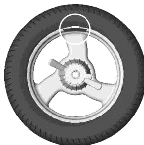
Рисунок 6.6 - Груз установлен в «12 часов»
