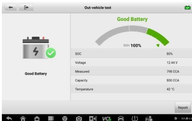
***Рисунок 9-14. Пример окна, содержащего результаты проверки вне автомобиля***
