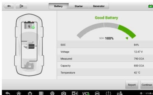
**Рисунок 9-7. Пример окна, содержащего результаты проверки аккумулятора**
