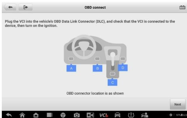
**Рисунок 9-4. Пример окна OBD Connect [Подключение OBD]**
