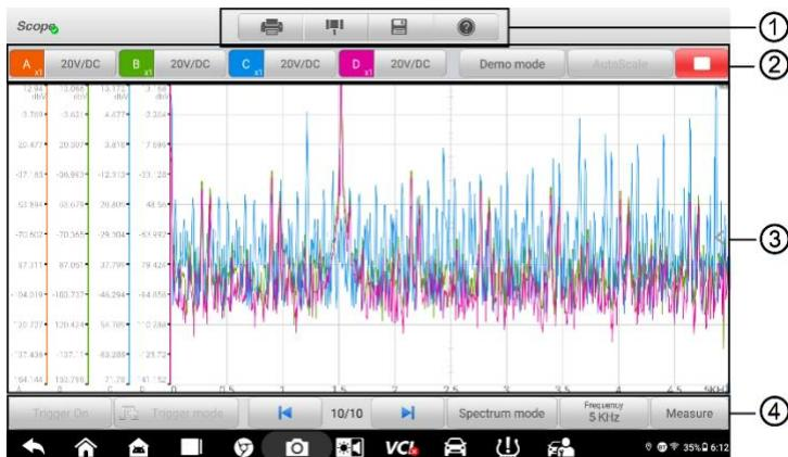
**Рисунок 19-4. Пример структуры окна приложения Oscilloscope [Осциллограф]**
