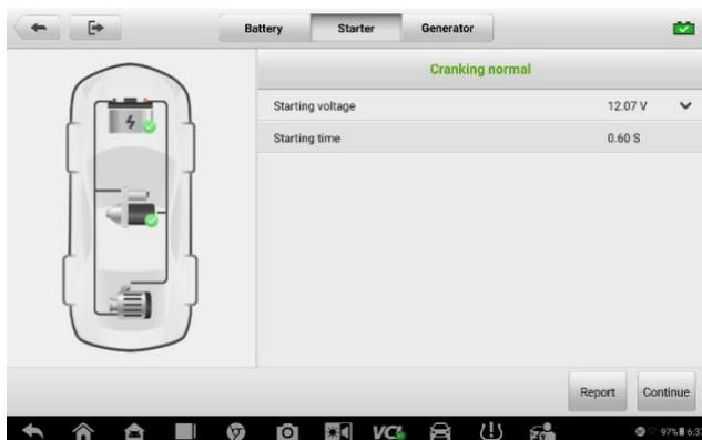
**Рисунок 9-9. Пример окна, содержащего результаты проверки стартера**
