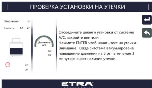
с) Проверка оборудования на утечки.
