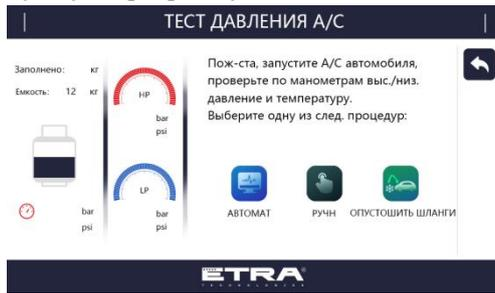
6-а) Выберите режим Automatic (АВТОМАТ) и следуйте инструкциям на экране.
