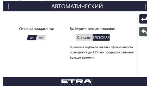
С) Выберите, проводить ли вакуумирование, задайте разрежение, время и параметры проверки на утечки. Для перехода к следующему шагу нажмите
