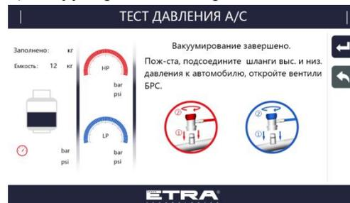
5) Следуйте инструкциям на экране. Выберите нужную программу.
