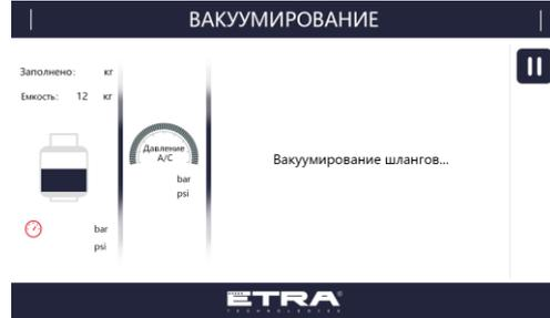
е) Вакуумирование завершено. Далее действуйте, согласно инструкциям на экране. Для регенерации нажмите
