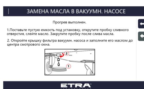
e) При заливке свежего масла следуйте инструкциям на экране.
