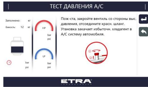
8) Регенерация хладагента в автомобильной системе кондиционирования.
