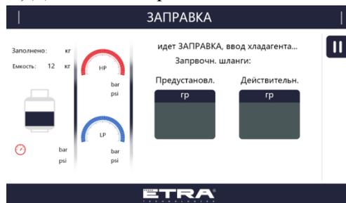
L) По завершении заправки включите систему кондиционирования и проверьте давление.
