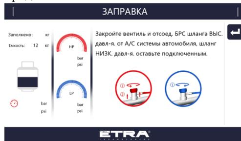
N) Действуйте, согласно инструкциям на экране, для продолжения нажмите .
