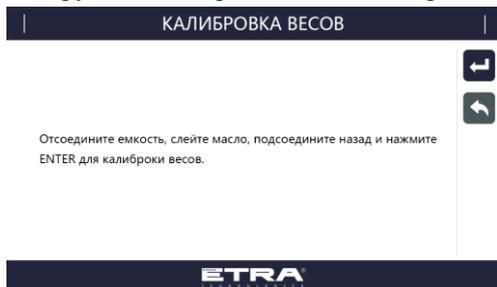
б-2) Следуйте инструкциям на экране.
