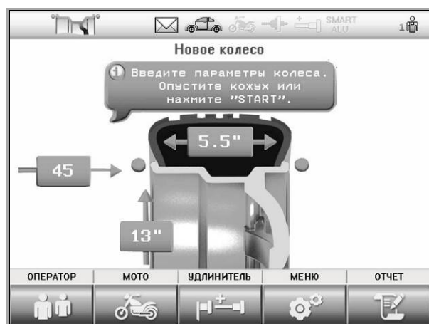
Рисунок 4.8 – Состояние «Новое колесо»
