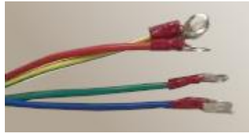
Рисунок 3.15 – Провода для подключения электродвигателя Красный, синий, зелёный – фаза Жёлтый – Земля
