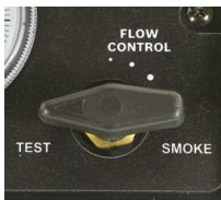
Abb. 2: Rauchstromregler in Einstellung "TEST"
