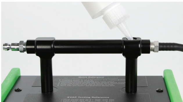
Afb. 5: Vullen met de UltraTraceUV® rookplossing
