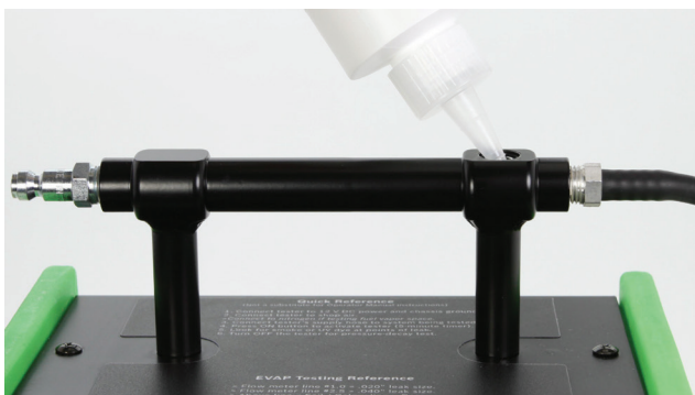
Obr. 5: Plnění roztoku UltraTraceUV® ke generování kouře
