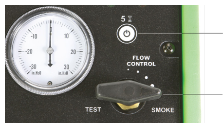
Fig. 9: Rökflödesreglaget är helt öppet
