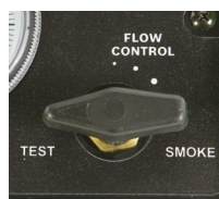
Рис. 2: Регулятор потока дыма с настройкой "TEST"
