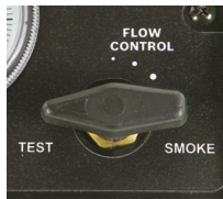
Kuva 2: Savuvirtasäädin säädössä "TEST"
