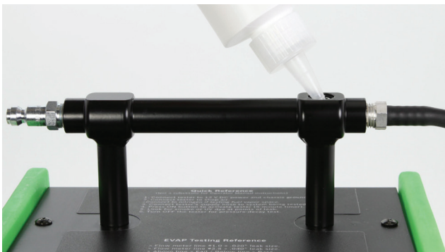
插图 5: 填充 UltraTraceUV® 烟溶液
