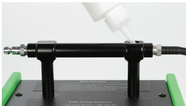
Fig. 5: Påfylling av UltraTraceUV® røykblanding
