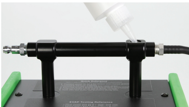
Fig. 5: Påfyldning af UltraTraceUV® røgopløsning
