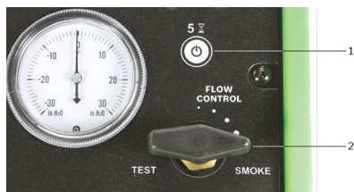
插图 9: 完全打开烟气流量控制器
