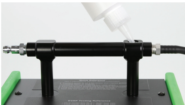
Abb. 5: Einfüllen der UltraTraceUV® Rauchlösung
