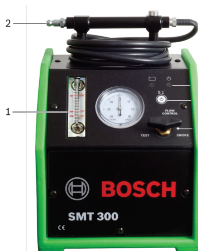
Fig. 8: Controllo EVAP con SMT 300
