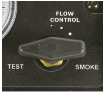
Şek. 2: Duman akımı ayarlayıcısı "TEST" ayarındadır
