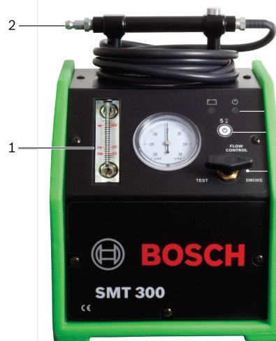
Fig. 8: EVAP-kontroll med SMT 300
