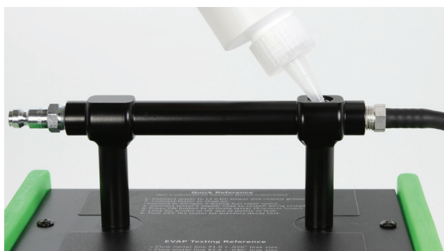
Rys. 5: Napełnianie roztworem dymowym UltraTraceUV®
