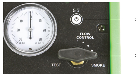
Fig. 9: Røykstrømregulator fullstendig åpen
