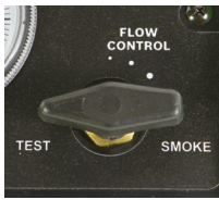
插图 2: “TEST” 设置中的烟气流量控制器
