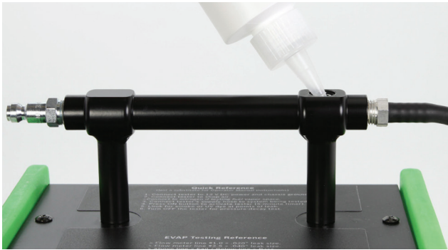
Fig. 5: Fyll på UltraTraceUV®-röklösning
