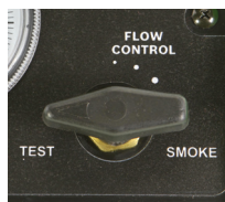
Fig. 2: Røgstrømsregulator i indstilling "TEST"
